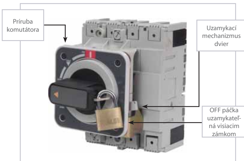
Rukoväť montovaná na ističi, uzamknutá visiacim zámkom v polohe OFF
